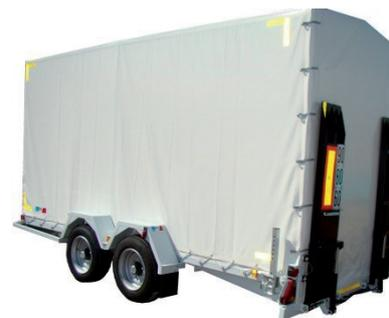
plateau avec pan arrière cassé pour transport d'engin avec garde au sol faible
