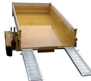
1 porte arrière pour version bennage et 2 rampes de chargement en aluminium avec emplacement à l'avant
